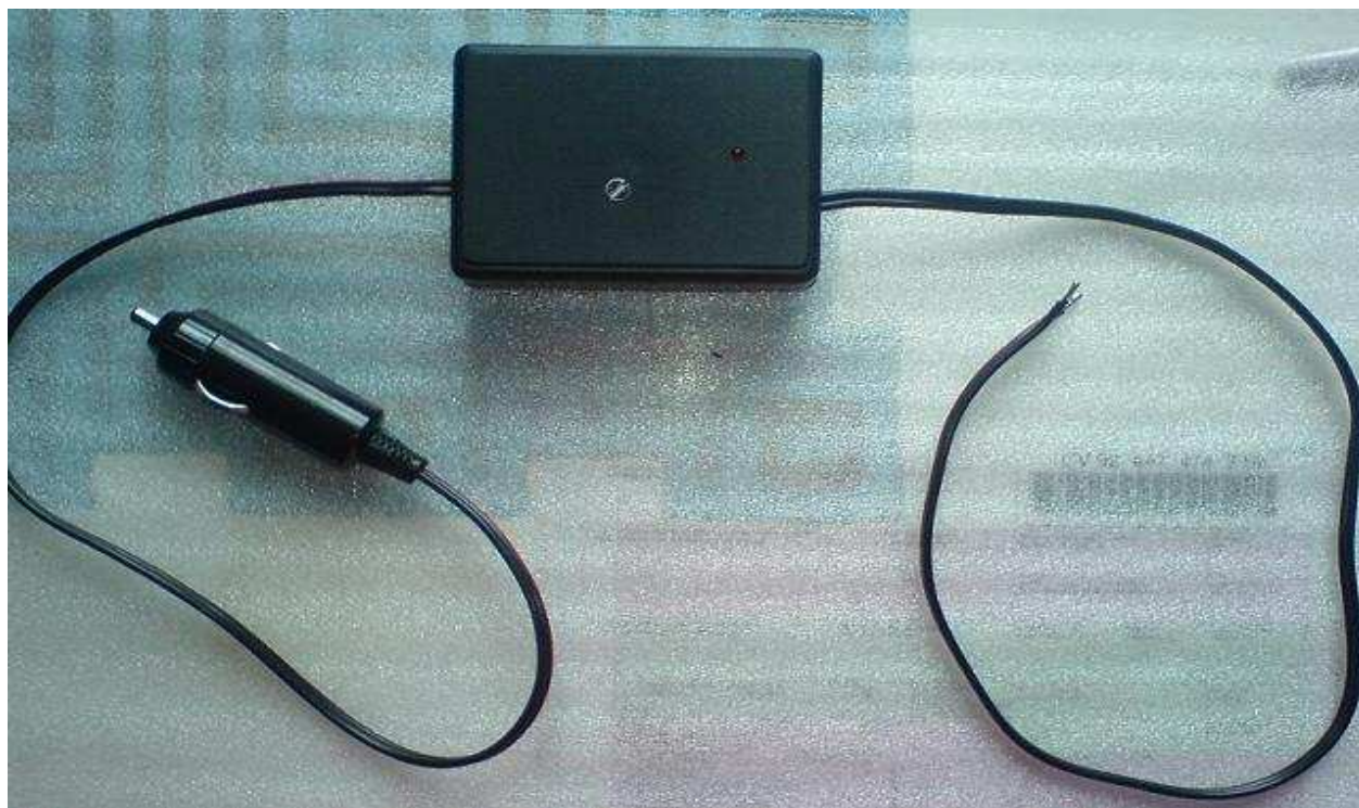
Obr. 6.4: Menič osadený v plastovej krabici s prívodnými vodičmi
